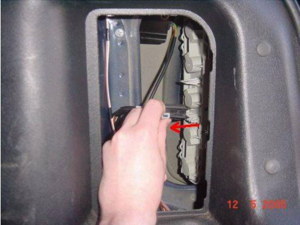
Wir kippen den Lampenträger oben nach hinten heraus (a) und heben ihn anschliessend an der Unterseite nach oben weg (b).
