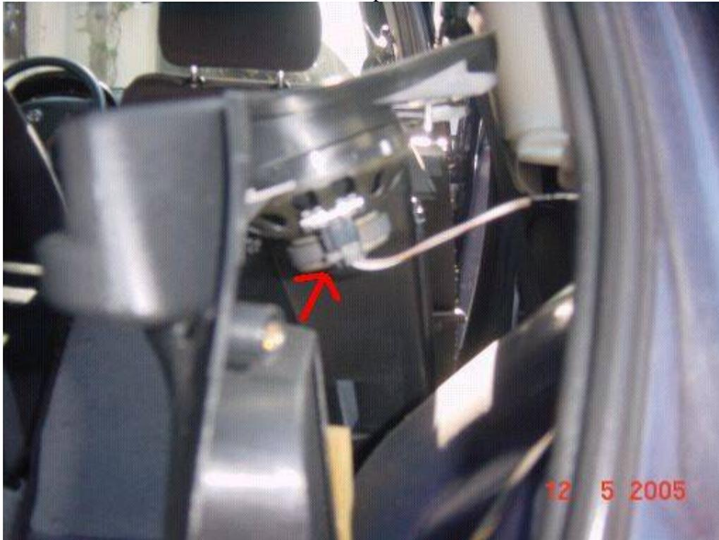
Die Rückleuchte wird durch 3 Schrauben gehalten, die es zu lösen gilt.
