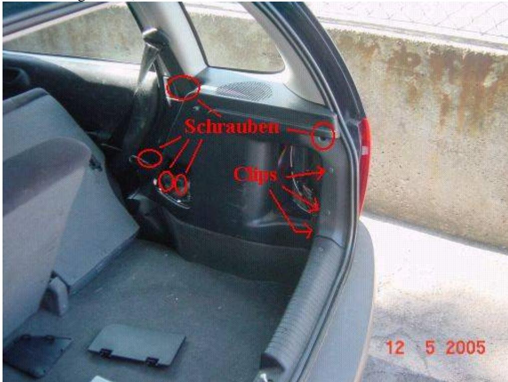
Eine der Schrauben wird durch den Gurt verdeckt.
