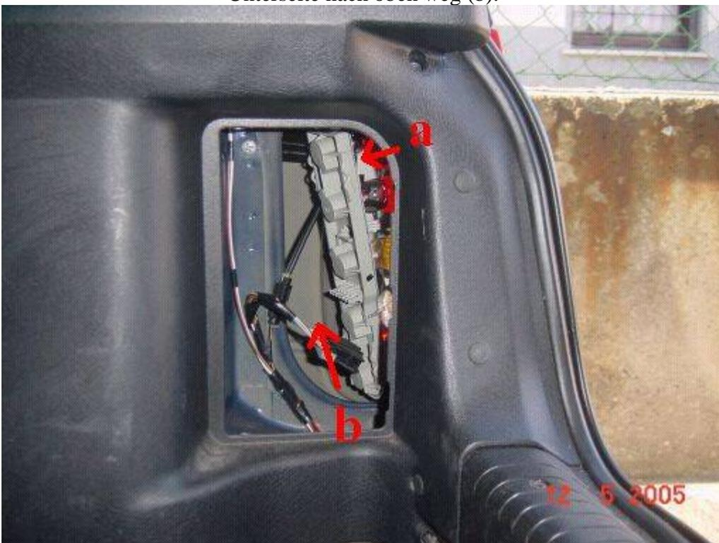
Nun lösen wir die Seitenverkleidung, damit wir nachher besser an die Schrauben der Rückleuchte rankommen. Dazu müssen wir 3 Torx-Schrauben an der Verkleidung lösen und 2 Torx-Schrauben, die die Arretierung der Rückbank halten. Zusätzlich wird die Verkleidung noch von 3 Plastikclips gehalten, die wir mit Gewalt einfach rausziehen können.
