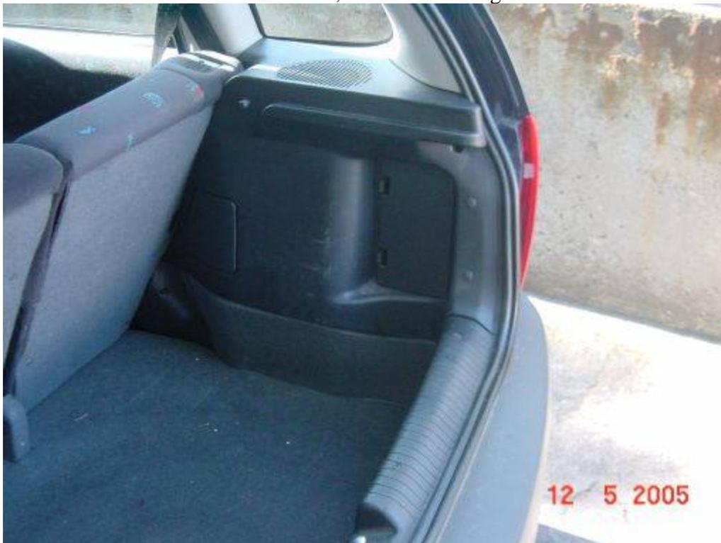
Als erstes entfernen wir die Abdeckung der Rückleuchte und ziehen den Stecker vom Lampenträger ab.
