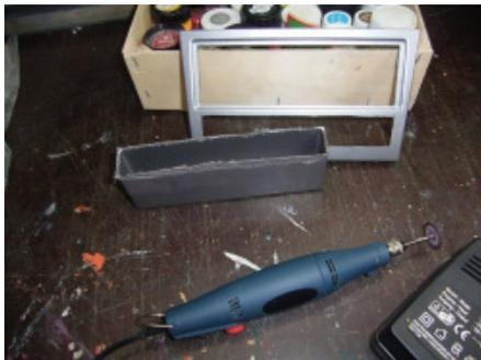
Mit dem Dremel trennen wir das Fach unter dem DIN Slot heraus. Das geht am besten mit einer Trennscheibe oder mit einem Fräser:
