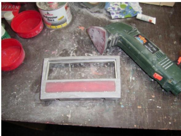
Nun muss die Fläche noch glatt geschliffen werden: Das geht am besten mit einem Delta- oder Bandschleifer. Ich habe für das Größte 40er Schleifpapier genommen, und anschließend den Rest mit 120er geschliffen. Die kleinen Unebenheiten werden noch rausgespachtelt:
