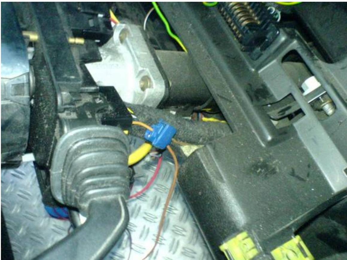
Jetzt müssen die Kabel nur noch nach obigem Schaltplan angeklemt werden. Die Relais kann man wunderbar hinter dem Tacho verstecken.
