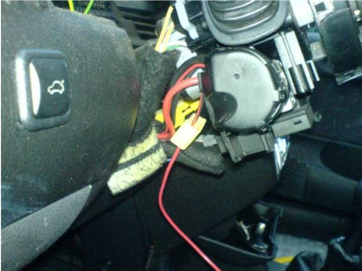
Nachdem nun der Tacho ausgebaut wird, der einfach durch 2 Schrauben befestigt ist, werden auf die selbe Weise nun das blau-weiße Kabel des Tachosteckers und das braune Kabel des Scheibenwischerhebels abgegriffen:
