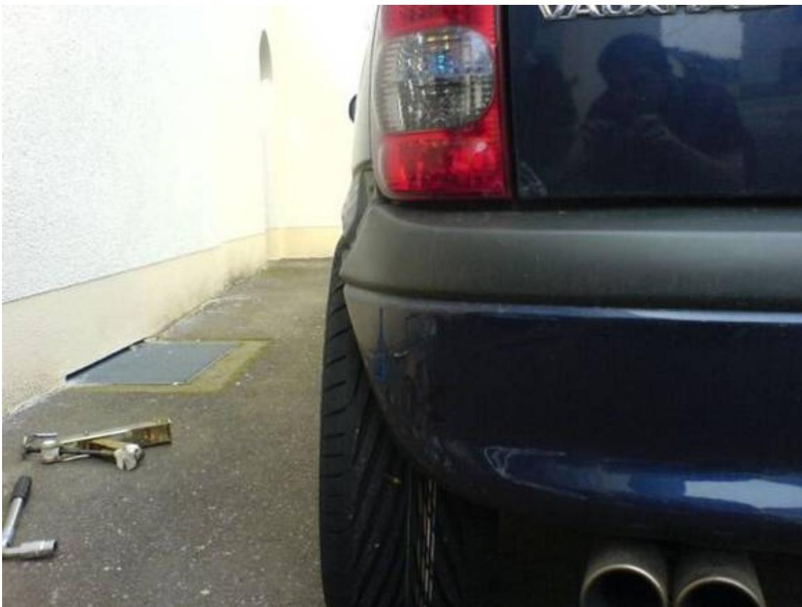
In diesem Fall handelt es sich um eine 7x16 Zoll Felge mit einer ET von 35 und der Bereifung von 215/40/R16.
