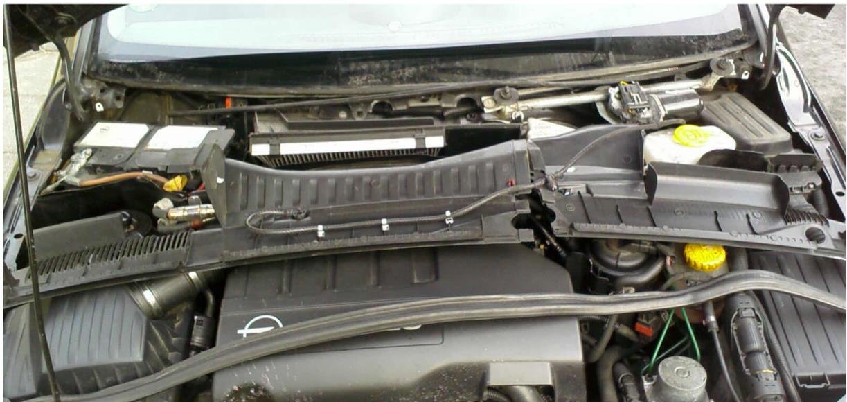
Anschließend müsst ihr nur die Rastnase !!VORSICHTIG!! (Ich hab eine abgebrochen) nach hinten drücken und die Düsen von der Oberseite rausdrücken. Sitten diese zu fest, legt eine Unterlage unter die Düse und drückt die Abdeckung runter, dann rutscht sie Euch entgegen:
