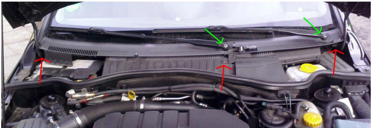
Anschließend einfach die Dichtlippe abziehen und ihr könnt die Abdeckung auf den Kopf gedreht auf den Motor legen, so kommt man Prima an alles ran:
