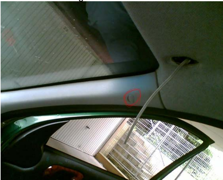
Kabelverlegung, Rot ist die Schraube der A-Säulenabdeckung
